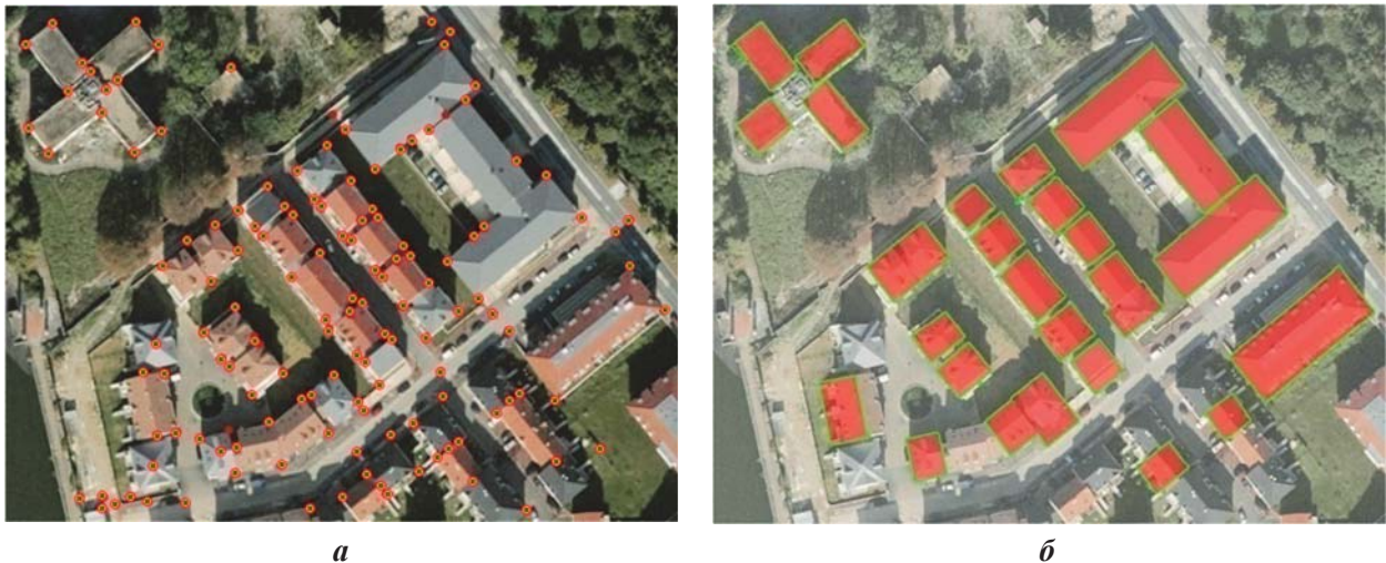
a – исходное изображение и найденные углы 90^\circ ; б – выделенные здания
