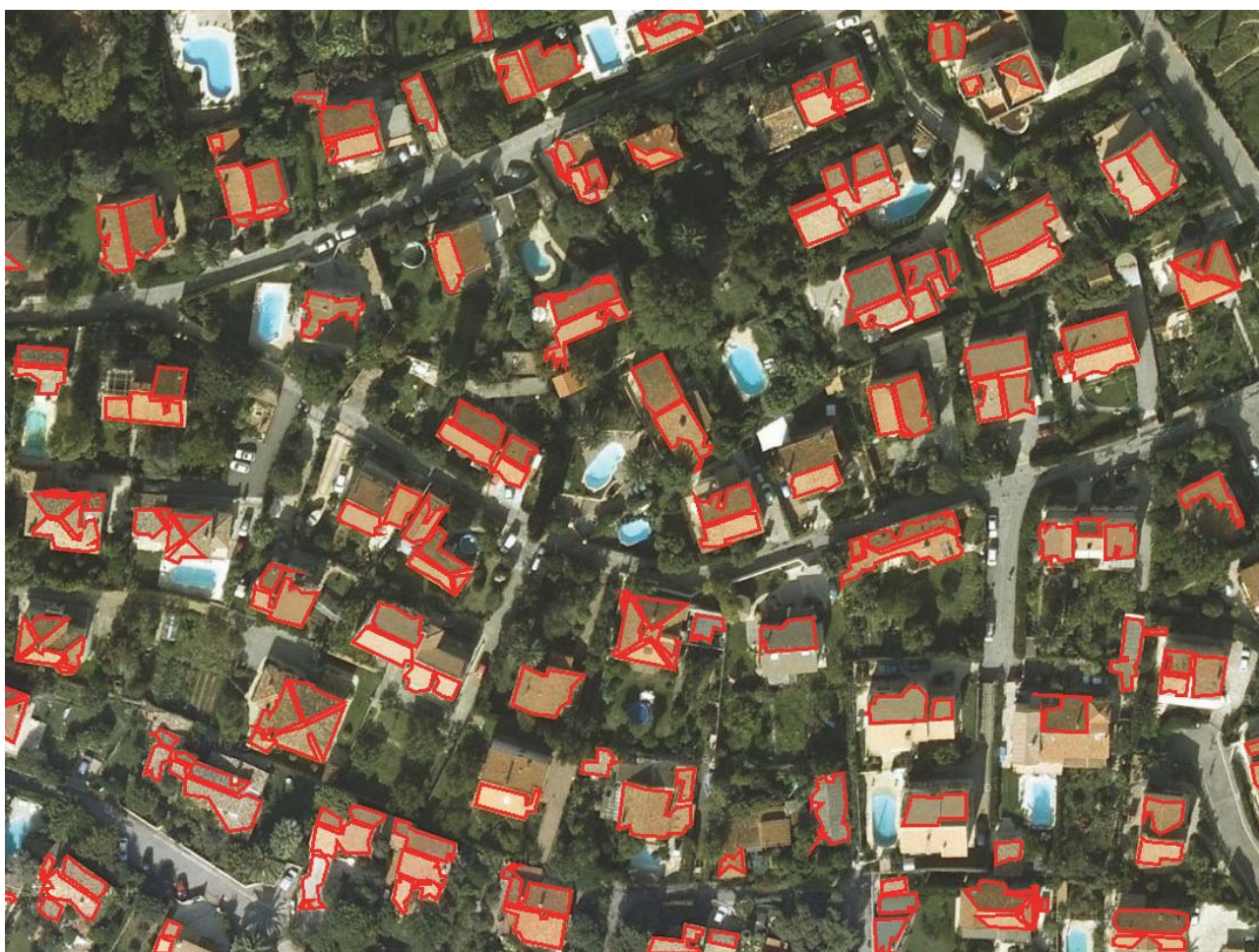
Рисунок 5. – Результат автоматического выделения зданий на изображении (фрагмент) классификатором D(C) . Красным контуром выделены обнаруженные части зданий
