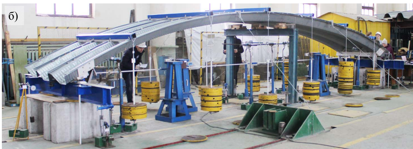
1 – фрагмент покрытия; 2 – деталь опорная; 3 – балка опорная; 4 – тяж; 5 – блок бетонный; 6 – траверса; 7 – подвес с грузами; 8 – страховочная рама; 9 – оттяжка; 10 – затяжка а) схема установки для испытаний; б) общий вид установки для испытаний
