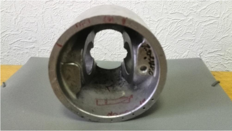
Рисунок 5. – Первая и третья серия сверлений различных диаметров, расположенных на торцевых поверхностях поршня
