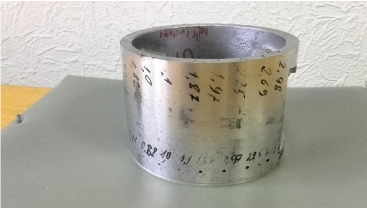
Рисунок 6. – Вторая серия сверлений различных диаметров, расположенных на наружной цилиндрической поверхности поршня
