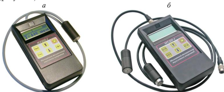
Рисунок 7. – Магнитодинамические толщиномеры специальных покрытий камер ЖРД, созданные в ИПФ НАН Беларуси: a – прибор МТНП-1, позволяющий измерять толщину никелевого покрытия; б – прибор МТДП-1 для толщинометрии слоев двухслойного хромоникелевого покрытия
