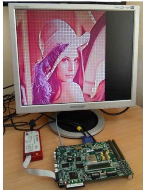
Рисунок 7. – FPSoC-компрессии изображений на XC4 VLX25-FF668-10 Xilinx ML-401
